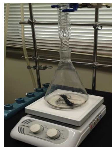
電解液でのCFRP溶解状況
